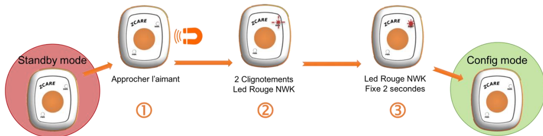
Figure 3 : Procédure d'intégration du produit ZCare dans un réseau ZigBee®
