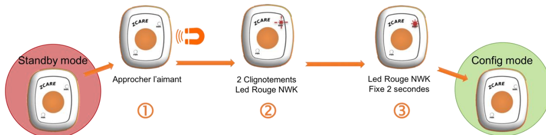
Figure 7 : Procédure de basculement en mode de configuration
