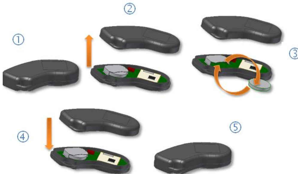
Figure 3 : mode opératoire pour un changement de pile
