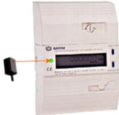
Connecter le connecteur jack mâle 3,5 mm du capteur au connecteur jack femelle du compteur de consommation.
