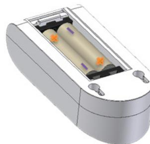
Remettre le couvercle sur le ZMETER en le faisant glisser jusqu'à ce qu'il soit clipser.
